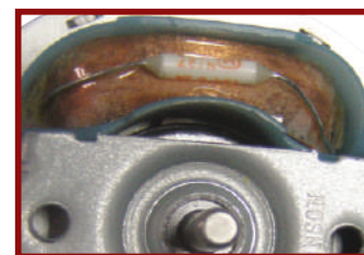
Motor sa termičkom zaštitom Motor with thermal protection
